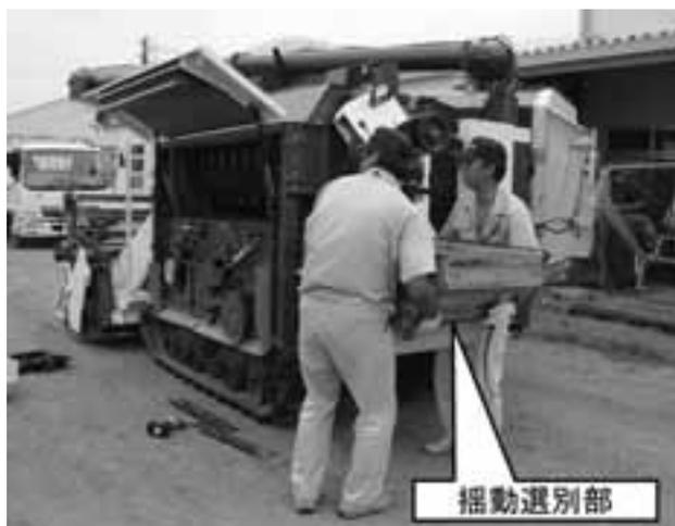
図4 スライド引き抜き式揺動選別部
