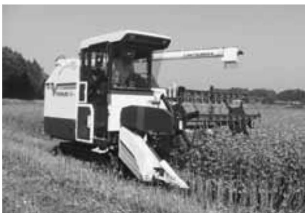
図8 小型汎用コンバインによるソバ収穫作業
