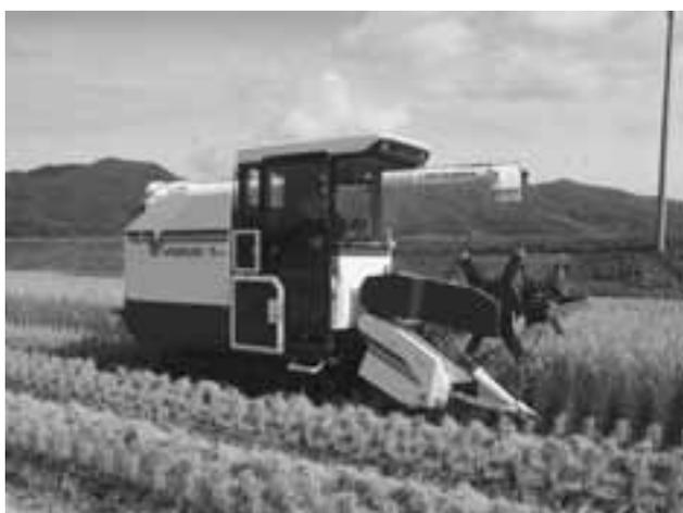
図5 小型汎用コンバインによる水稻収穫作業
